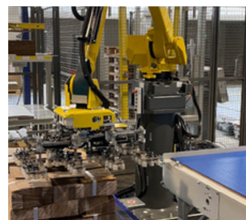
MuKPal PE (Packing Edge) rozwiązanie zrobotyzowane z funkcją ssania
